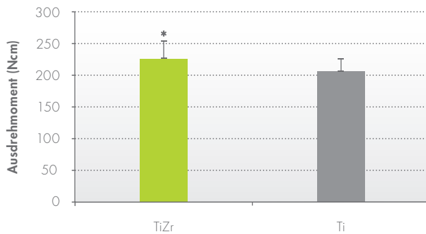
Abb. 1: Ausdrehmomentwerte für TiZr (Roxolid®) ggü. Ti (* p < 0,05 ) 5
